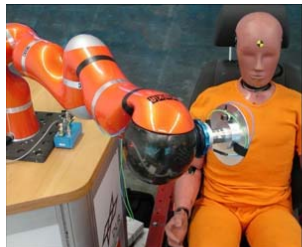
Un « crash test » impliquant le bras robotique mis au point au DLR (Allemagne). Le bras s'apprête à simuler ce que ne devrait jamais faire un robot : frapper un être humain. © Institute of Robotics & Mechatronics/DLR
