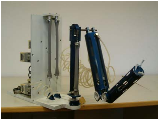
GioSte, il braccio sviluppato al Centro Piaggio per testare il VSA-II
